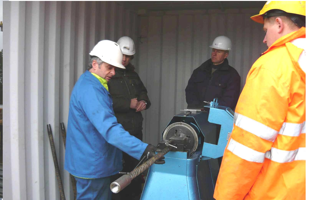
Srieginiai armatūros strypų sujungimai. Projektas: Vilniaus vakarinis aplinkelis 2009 - 2010, rangovas AB "Panevėžio keliai"
